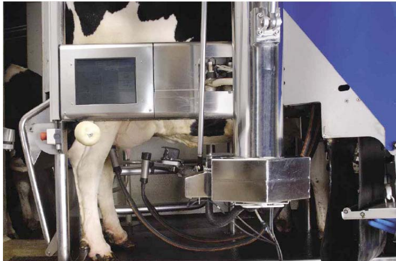
Bild 3. Spenkopparna sätts på av den hydrauliska robotarmen
